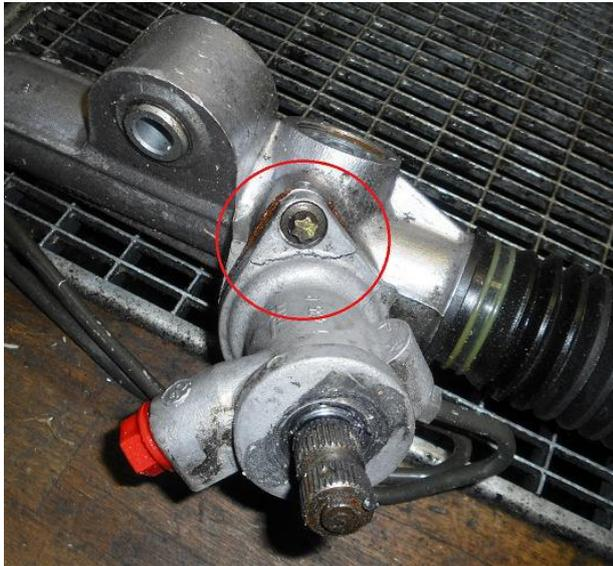
Gehäuse stark korrodiert / beschädigt
