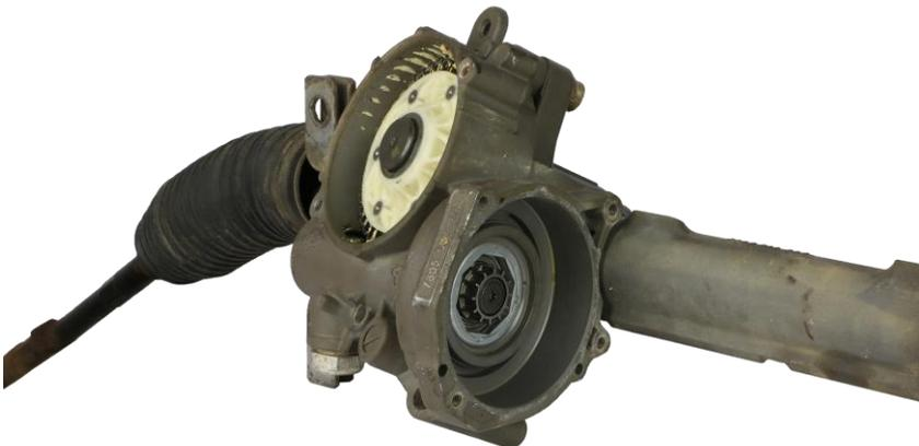
Bei Kugelumlaufnuten: zu starke Korrosion / Verschleiß der Lenksegmentwelle (nach Prüfung)
