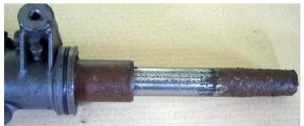
Wassereintritt oder extreme Korrosion des Gehäuses bei elektrischen Bauteilen
