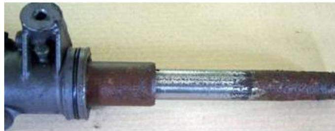
Wassereintritt oder extreme Korrosion des Gehäuses bei elektrischen Bauteilen
