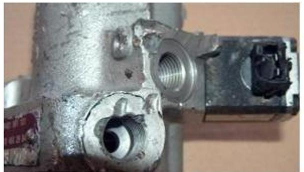
Spindelverzahnung stark beschädigt
